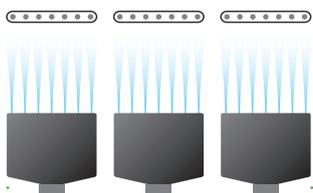
一般的なフラットノズルは噴射口がスリット状または複数に分かれています。断面積が大きくなるため、エアの消費量が多くなる一方で、打力は小さくなります。
