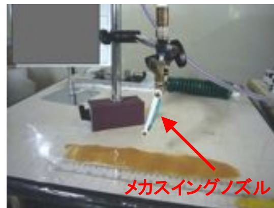
写真4 メカスイングノズルの測定
